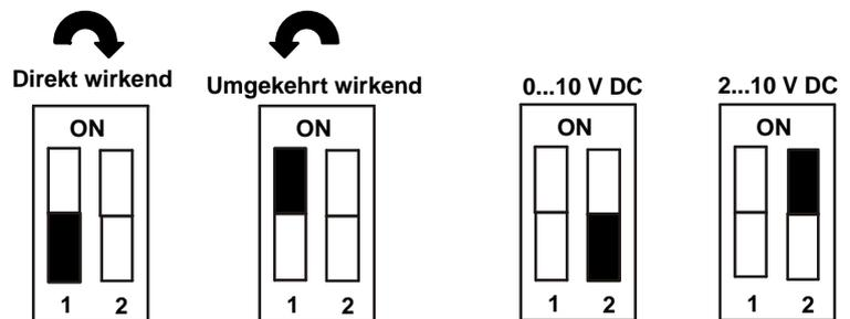
Um die Werkseinstellung zu ändern, müssen Sie das Gehäuse des Antriebs entfernen und die DIP-Schalter wie folgt einstellen:
