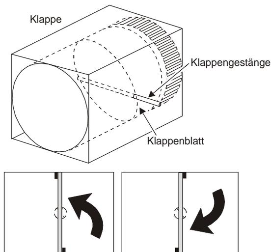
Gegen den Uhrzeigersinn zu schließen    Im Uhrzeigersinn zu schließen
