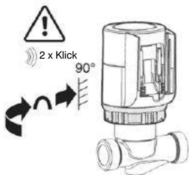
Drehen Sie den Bajonett-Verschluss, bis Sie zweimal ein Klicken hören. Diese Position ist eine Sicherheitsposition, die einen Vibrationsverlust vermeidet. Während der Drehung des Verschlusses, stellt sich der Antrieb auf den Hub des Ventils ein.
