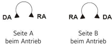
Die Antriebe haben eine Einstellschraube, mit der der Wirksinn eingestellt werden kann.
