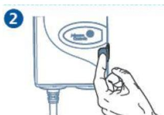
Drücken Sie die Taste für die Handbedienung am Antrieb.
