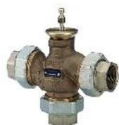
Mischventil (Durchgang NC: Spindel oben=Durchgang zu, Eckdurchgang NO: Spindel oben=Eckdurchgang auf)
