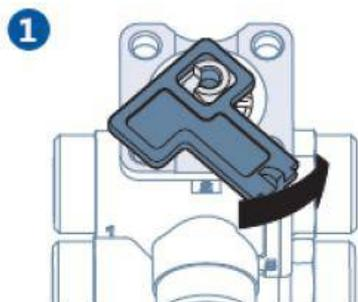
Benutzen Sie den Schlüssel, um die Spindel des Kugelhahns in einem 90° Winkel auszurichten, weg vom runden Ausschnitt
